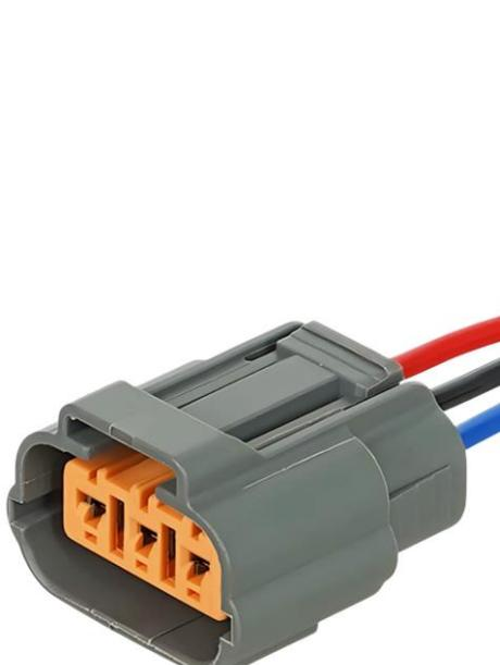
**НАЗВАНИЕ (полное):** Разъём 3 pin без проводов для катушки зажигания Nissan Qashqai, Mazda 3, 6, Honda Insight
